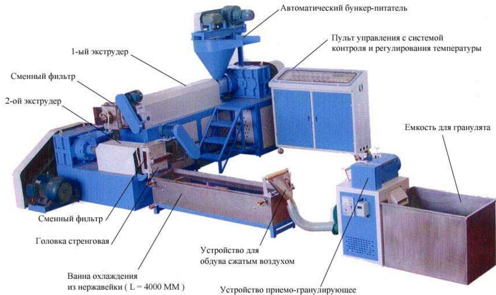
Схема 2-ух секционного гранулятора:
